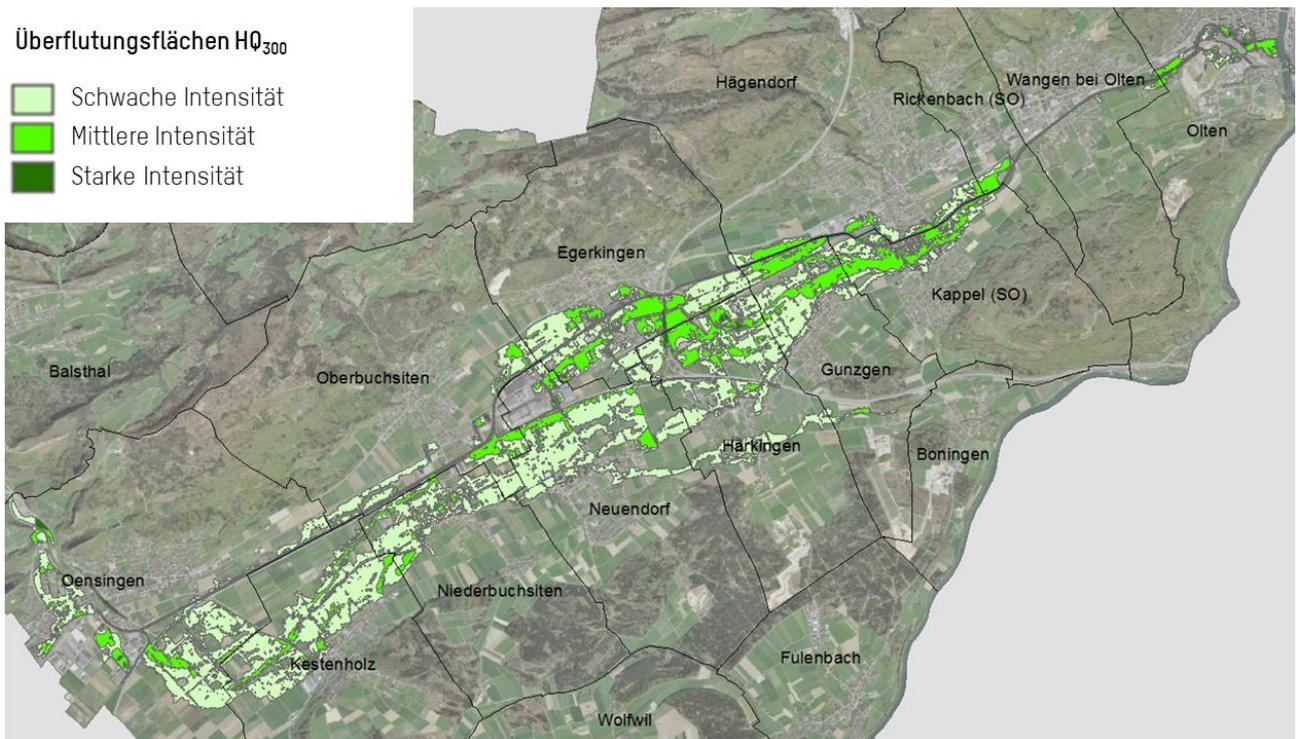
Abbildung 15: Intensitätskarte Hochwasser Dünnern, Ist-Zustand HQ<sub>300</sub> mit «Bruttobetrachtung» [23].
