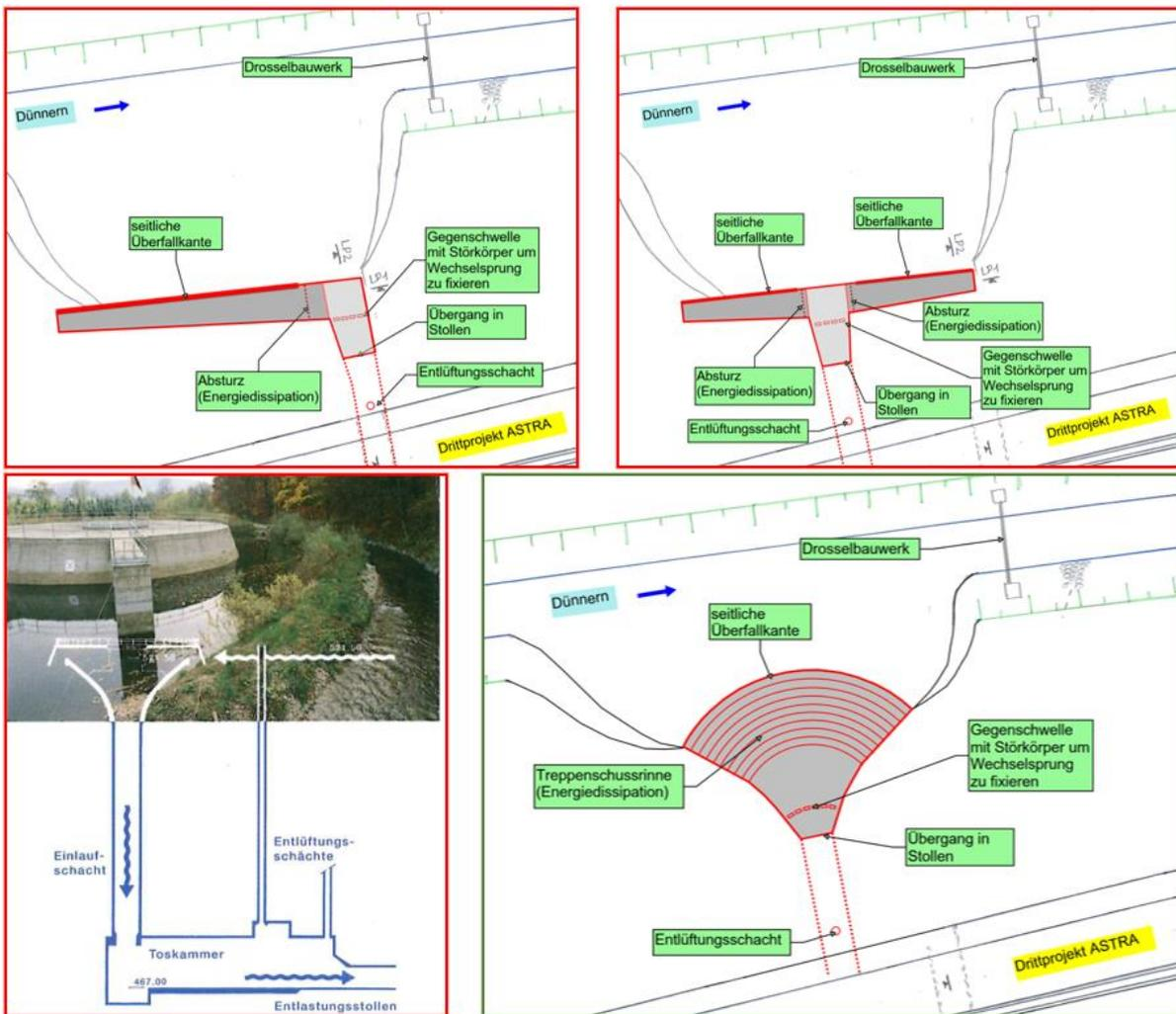
Abbildung 128: Skizzen der diskutierten Varianten des Entlastungsbauwerks: Einseitiger Sammelkanal (oben links), zweiseitiger Sammelkanal (oben rechts), Einlaufstulpe (unten links), Treppenschussrinne (unten rechts). Rot umrandete Varianten wurden verworfen.
