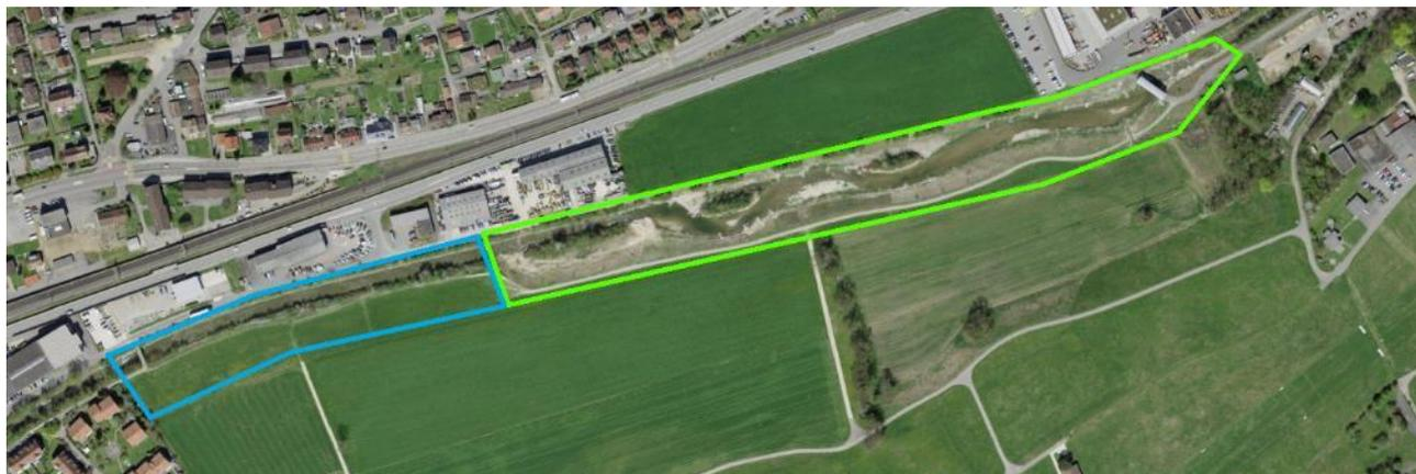
Abbildung 27: Als Ausgleichs- und Ersatzmassnahme (AEM) des Strassenbauprojekts «Entlastung Region Olten Kantonsstrasse H5b» aufgewerteter Abschnitt der Dünnern (grün) sowie verbleibender Abschnitt, welcher in das vorliegende Projekte integriert wird (blau).
