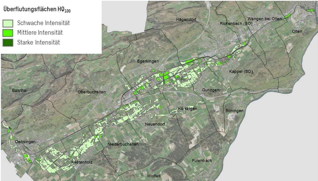
Abbildung 14: Intensitätskarte Hochwasser Dünnern, Ist-Zustand HQ<sub>100</sub> mit «Bruttobetrachtung» [23].
