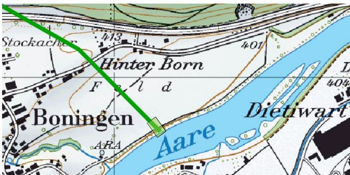
Abbildung 21: Situation Gunzgen-Boningen 2), Auslaufbauwerk (hellgrün)
