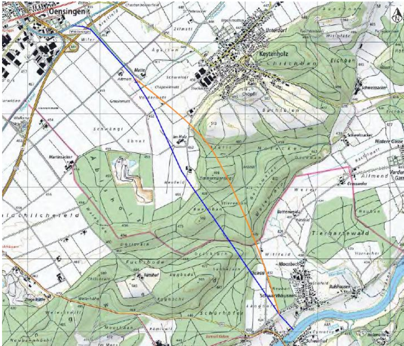
Abbildung 3: Variante 1a) (blaue Linie) und mögliche Verschiebung nach Osten zur Verringerung des Lockergesteinsabschnitts (orange) [gemäss SC+P, Anhang 5]
