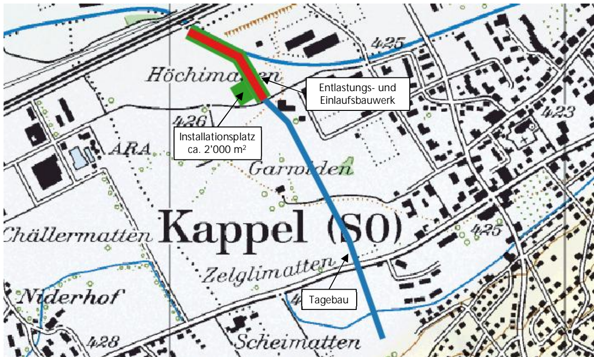
Abbildung 24: Variante 2), Raumbedarf Entlastungs- und Einlaufsbauwerk: permanent (rot) und temporär (grün), zusätzliche temporäre Flächen bei Tagebau (blau)
